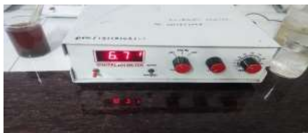
Img no.17 pH meter
