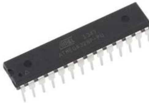
Fig. 5 Atmega328 Chip
